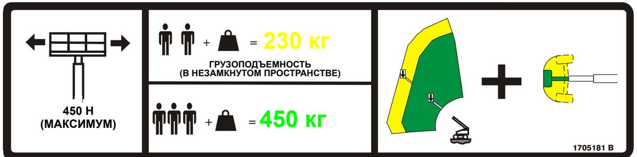
Рис. 4-1. Наклейка двойной грузоподъемности
